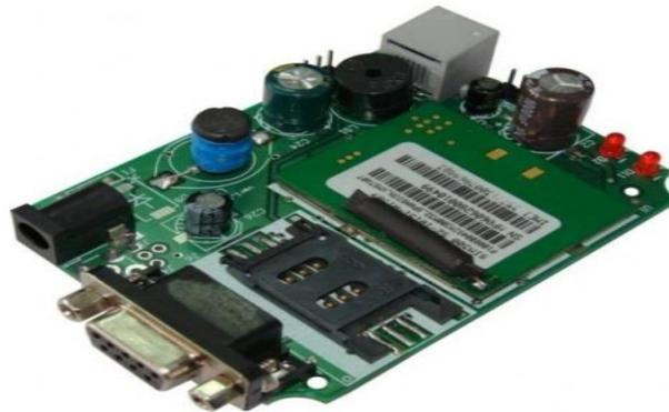
Figure.2. GSM module
