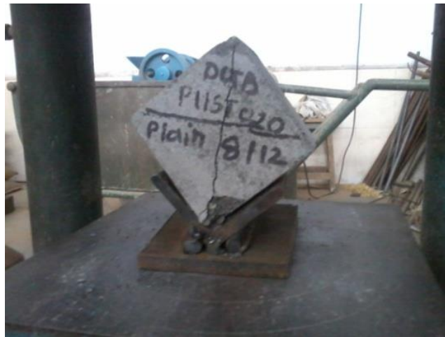
Fig 2(b) Split tensile test actual practice
