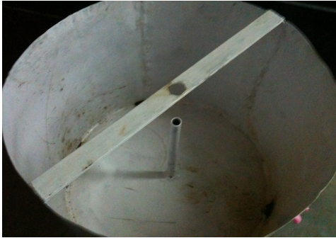
Fig. 6 - Jominy End Quench Test apparatus
