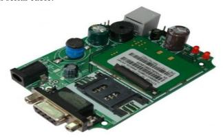
Figure.2. GSM module
