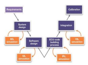
Figure 4 - MiL, SiL, PiL, HiL across V-Cycle
